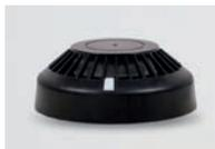
**Detector óptico de humos intrínsecamente seguro** para aplicación en zonas con atmósfera potencialmente explosivas. Dispone de un circuito de compensación capaz de mantener la sensibilidad constante y corregir las variaciones ambientales. Dispone de cámara extraíble para limpieza o reposición. Led indicador de estado. Alimentación 12 – 28 Vcc, 20 mA en alarma. **Base G-40 no incluida.** Diámetro 115 mm. **Certificado** N° KDB 04ATEX190X otorgando clasificación II 2G EEx ib IIC T6.
