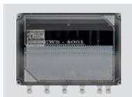
Módulo direccionable de 8 salidas independientes. Conexión directa al bucle y **aislador de cortocircuitos incorporado**. Salidas de contacto libre de tensión independientes para ejecutar maniobras desde la central según diferentes criterios. (control de retenedores, sirenas de tensión, ascensores, compuertas... etc) NA-NC (2 A a 30 V) con indicación individual en la central. Led indicador de estado. **Incluye caja IP-65**. Medidas 250 x 195 x 75 mm. Certificado EN54-18.
