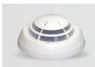
**Detector óptico de humos autónomo** para aplicaciones domésticas o similares, dispone de una alarma audible de 85 db, pulsador de prueba y led de supervisión e indicación de estado y avería. Alimentación mediante pila alcalina de 9V con duración superior a dos años (**Incluida**). Posibilidad de interconexión en red entre varios detectores para mejor transmisión de la alarma. Fácil limpieza de mantenimiento de la cámara de detección. Certificado EN14604:2005 – N°: 1438/CPD/0145
