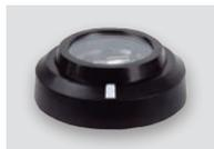
**Detector óptico de llamas intrínsecamente seguro** por detección de radiación ultravioleta similar al modelo PUO40, para aplicación en zonas potencialmente explosivas. Uso en interiores. Hasta 25 m. de alcance y 110 ° de apertura. Led indicador de estado y salida para piloto remoto. Alimentación 17 – 24 Vcc, 20 mA en alarma. Base modelo G-40 no incluida. Diámetro 115 mm. **Certificado** otorgando clasificación II 2G Ex ib IIC T6 Gb.
