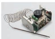
**Sonda térmica** regulable para aplicaciones especiales como zonas próximas a hornos, campanas extractoras, etc. Consta de una unidad de control con regulación entre 50 y 200°C ubicada en una caja metálica y una sonda externa para el análisis de la temperatura a distancia. Función modo detector o modo pulsador. Caja de acero inox. 100 x 100 x 100 mm. 10/30 V - 0/100 mA.
