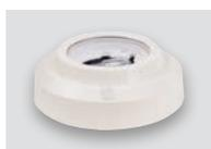
**Detector óptico de llamas** por detección de radiación ultravioleta en la longitud de onda de 200 nm. mediante electrodo colector en tubo de gas. Uso en interiores. Hasta 25 m. de alcance y 110 ° de apertura. Led indicador de estado y salida para piloto remoto. Alimentación 9 -28 Vcc, 20 mA en alarma. Base mod. G-40 no incluida. Diámetro 115 mm. **Certificado** EN 54-10:2002
