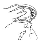
4) Insertar el detector en la base y girar en el sentido de las agujas del reloj hasta fijarlo en su posición:
